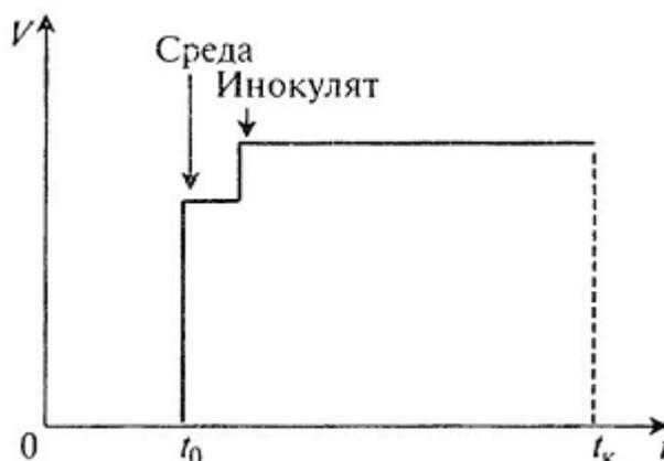
Рисунок 12 - Изменение объёма жидкости во времени в ходе батч-культивирования:  $t_0$  – время подготовки биореактора;  $t_k$  – время завершения процесса;  $V$  – объём среды в биореакторе
