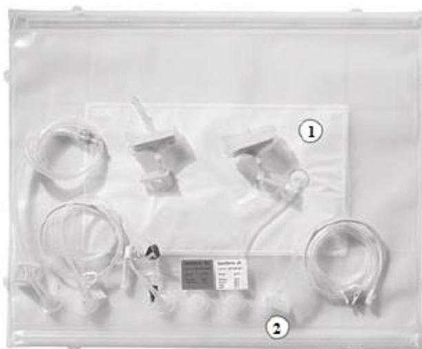
Рисунок 18 - Конструкция одноразового волнового биореактора Sartorius Flexsafe (Cultibag) RM в перфузионном исполнении: 1 – встроенная мембрана для отделения клеток, 2 – набор портов и трубок, имеющих различное назначение (отбор проб, подача среды и титранта для регулировки pH, отбор осветлённой культуральной жидкости, порты для световодов)
